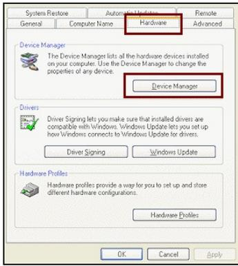
Fig. 9a – Determining the COM port
